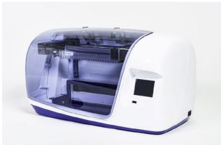
Le BDI I est un instrument qui réalise les différentes étapes d'incubation et de lavage des bandelettes immunodot de D-tek, du dépôt de l'échantillon au développement final de la couleur. La capacité maximale est de 24 bandelettes qui sont incubées simultanément. Chaque bandelette est associée à une cartouche contenant les différents réactifs permettant de réaliser le test. Le BDI I dispose d'un lecteur de code-barres qui contrôle la bonne association entre une bandelette et sa cartouche.
