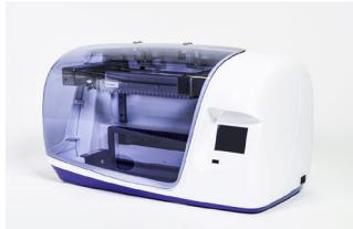
Le BDI I est un instrument qui réalise les différentes étapes d'incubation et de lavage des bandelettes immunodot de D-tek, du dépôt de l'échantillon au développement final de la couleur. La capacité maximale est de 24 bandelettes qui sont incubées simultanément. Chaque bandelette est associée à une cartouche contenant les différents réactifs permettant de réaliser le test. Le BDI I dispose d'un lecteur de code-barres qui contrôle la bonne association entre une bandelette et sa cartouche.
