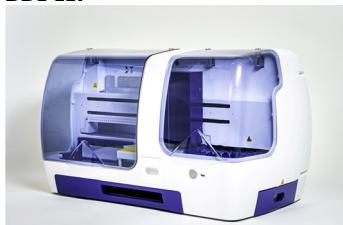
Le BDI II est un instrument qui réalise les différentes étapes de pipetage des échantillons, d'incubation, de lavage, de séchage et de lecture des bandelettes immunodot de D-tek, depuis le dépôt du tube d'échantillon jusqu'à la lecture finale des bandelettes.
