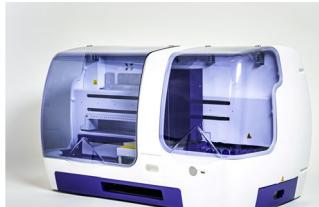
Le BDI II est un instrument qui réalise les différentes étapes de pipetage des échantillons, d'incubation, de lavage, de séchage et de lecture des bandelettes immunodot de D-tek, depuis le dépôt du tube d'échantillon jusqu'à la lecture finale des bandelettes.
